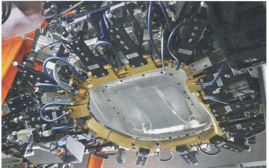
Bild 2, Stanzen und Umbugen in einem Schritt: Detailansicht des Oberwerkzeugs mit präzise auf das Bauteil abgestimmten Umbug-Schiebern und integrierten Stanzeinheiten.
